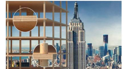
La **technologie TS3** permet une construction piliers-dalles en bois, ce qui n'était auparavant possible qu'avec du béton armé. Grâce à TS3, la construction en bois peut conquérir de nouveaux marchés et permettre de renoncer complètement à l'acier et au béton dans la construction à long terme.
