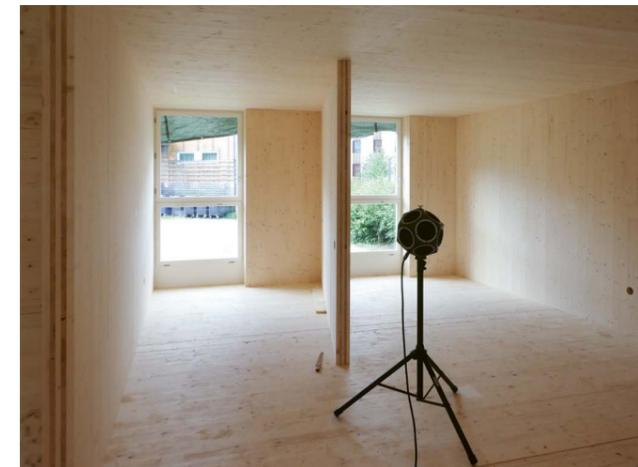
Des mesures acoustiques effectuées sur la maquette 1:1 ont permis de s'assurer que la méthode de construction choisie était appropriée avant le début du chantier.
