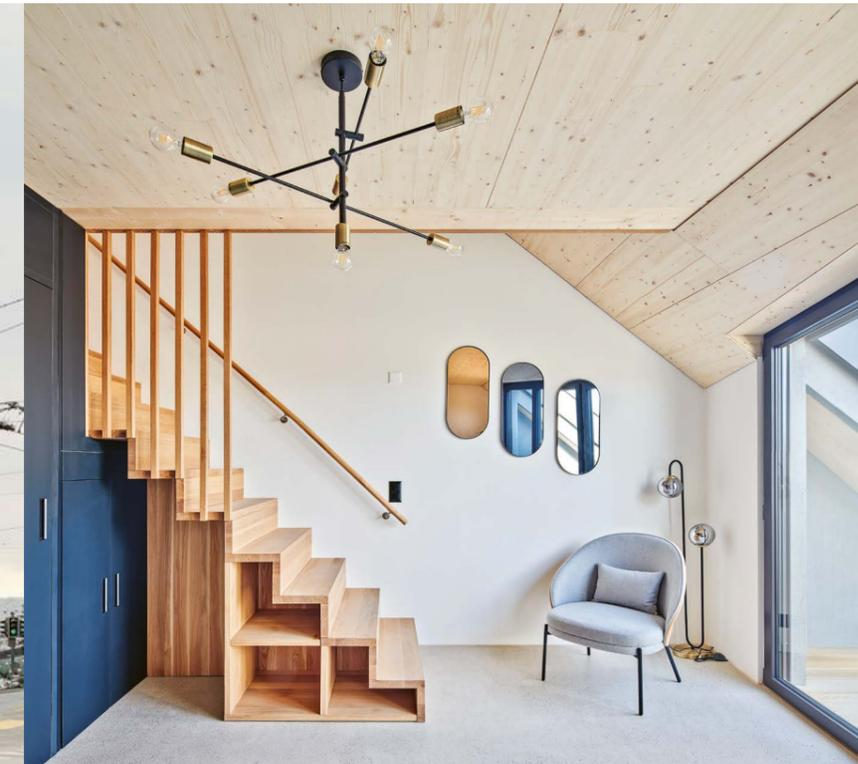
**Du bois dans toute la construction : les murs coupe-feu, les plafonds, la cage d'escalier et la cage d'ascenseur sont faits de panneaux de contreplaqué.**
