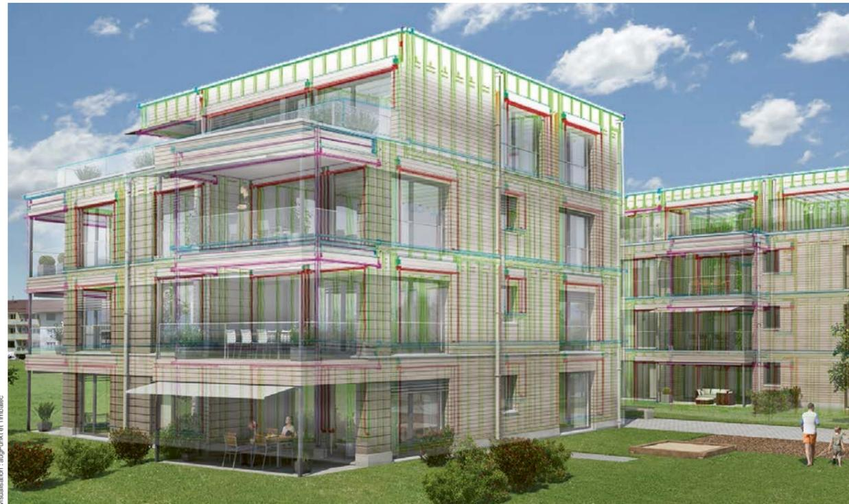
modèle 3D en étroite collaboration avec les constructeurs bois. La planification des installations de chauffage, de ventilation et de climatisation ainsi que les sanitaires et l'électricité sont intégrées. Les plans contiennent la coordination spatiale pour tous les éléments de construction et percées, les prescriptions pour le traitement et les informations concernant les matériaux de construction.
