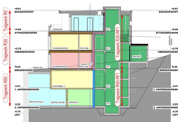
Schnitt mit den verschiedenen Brandabschnitten
