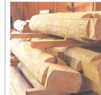
7 36 Weisstannen aus dem Wald von Lengnau (BE) wurden ausgesucht und mittels «Sylvatest» (5) durch Ultraschallwellen auf die mechanische Festigkeit des Holzes geprüft. Die Hölzer wurden im saffreien Zustand geschält, danach geschält und mit Längsnuten versehen, um die Schwindrisbildung zu begrenzen (6); danach wurden sie abgeschliffen und bearbeitet (7, 8, 9), um schliesslich in den Werkstätten zu grossen Rahmen zusammengefügt zu werden, mittels derer die auf den einzelnen Obergeschossen angebrachten Brettstichholzträger in Zangenkonstruktion gestützt werden (3).
