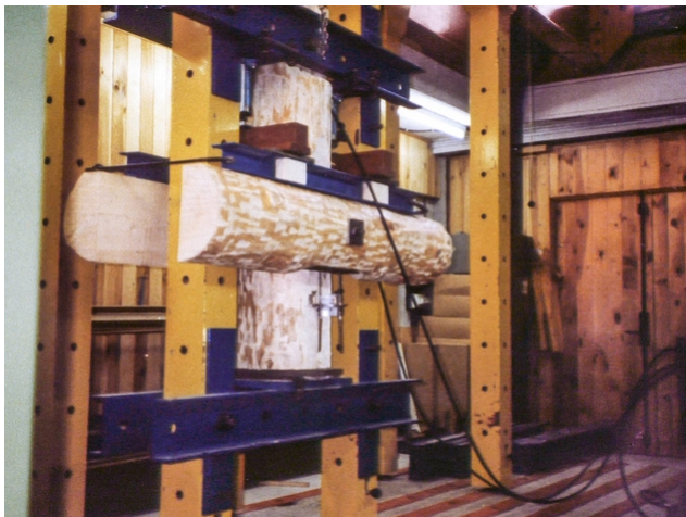
Entwicklung und Prüfung des Anschlussteils Zange-Pfosten...
