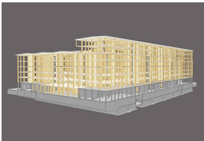
Nachhaltig und High-Tech: Das Tragwerk des Hauses Krokodil besteht zum Grossteil aus Holz. Die tragenden Stützen haben einen Abstand von 3 bis 4 Metern.
