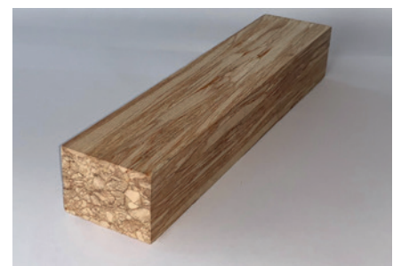
4 | Das Produkt Scrimber wird ab 2030 in grossen Mengen hergestellt und im tragenden Bereich eingesetzt.
