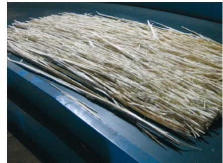
1 | Baumstämme und Äste werden mit grossen Walzen in einzelne Faserstränge zerkleinert.
