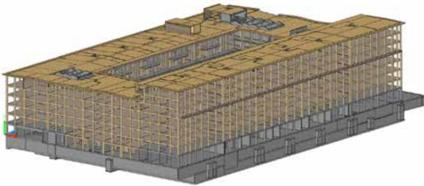
Bild 5: BIM-Modell „Krokodil“: Die Untergeschosse und ein Teil des Erdgeschosses sowie die Treppenhäuser sind aus Stahlbeton errichtet. Das Tragwerk des übrigen Gebäudes ist ein Holzskelett. (Bildquelle: Timbatec)
