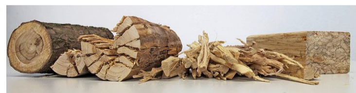
Beim Scrimber-Verfahren werden Baumstämme und Äste mit grossen Walzen in einzelne, spreisselartige Faserstränge zerkleinert. Die Spreissel werden danach mit Klebstoff angereichert und zu Bauprodukten in der gewünschten Form und Grösse verarbeitet. Foto: PD
